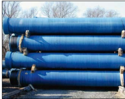
Bild 14.4: Duktile Gussrohre mit Zementmörtel-Umhüllung
